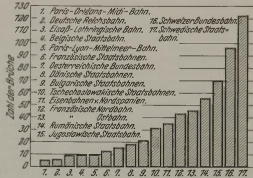
Abbildung 1. Zahl der Schienenbrüche auf 1 Milliarde t-km bei 17 europäischen Eisenbahnverwaltungen.
