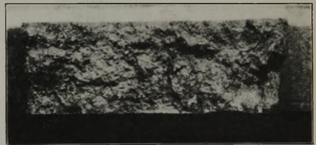
Abbildung 1. Bruchfläche in einer Kesselnietnaht mit körnigem Gefüge.
