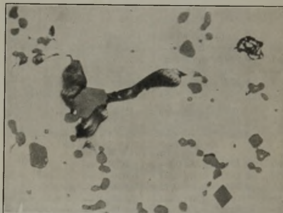
Abbildung 11. Ferromangan aus dem Elektroofen mit 1 % C und 80 % Mn.
