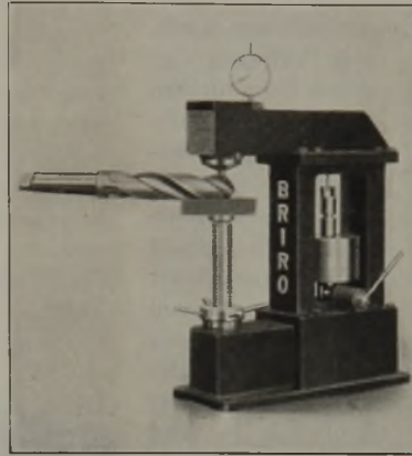
Abb. 16. Bauart Reicherter (Briro). (Verspannungsdruck 320 kg, Ausladung 150 mm, größte Höhe des Prüfstückes 350 mm.)
