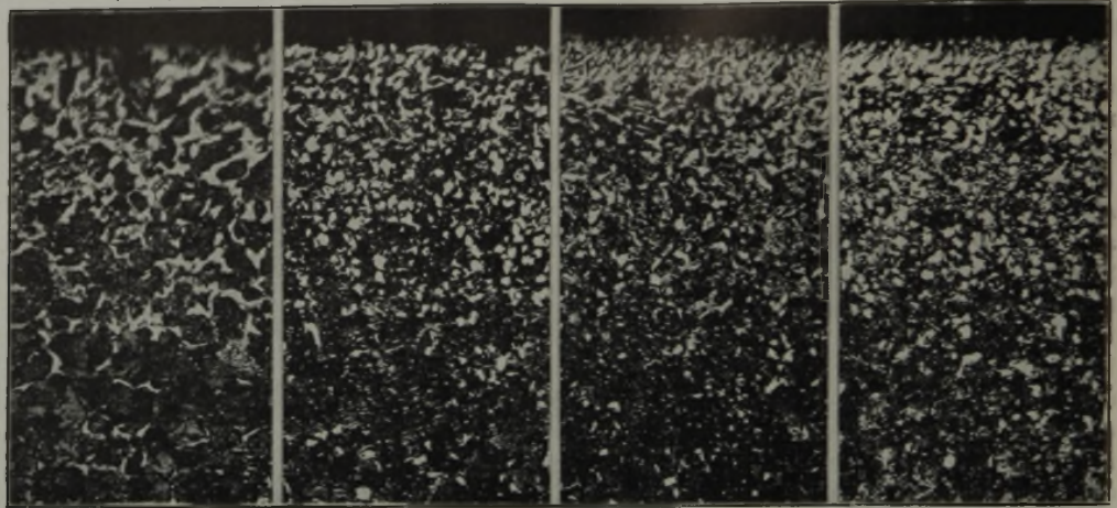
Abbildung 10. Ausbildung der Randzone eines Chrom-Molybdän-Einsatzstahles mit 0,22% C, 1,25% Cr und 0,24% Mo nach zwanzigstündiger Aufkohlung bei 830° in verschiedenen Einsatzhärtemitteln. (Bilder × rd. 300.)
