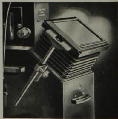
Abbildung 16. Reicherts Me F mit Balgenkamera.
