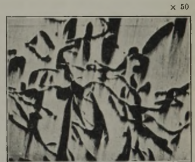
Abbildung 8. Härtetragschicht einer Blechwarmwalze. Grobflockiger, kurzadriger Graphit. Gute Leistung. \sigma_B = 20,2 kg/mm 2 .
