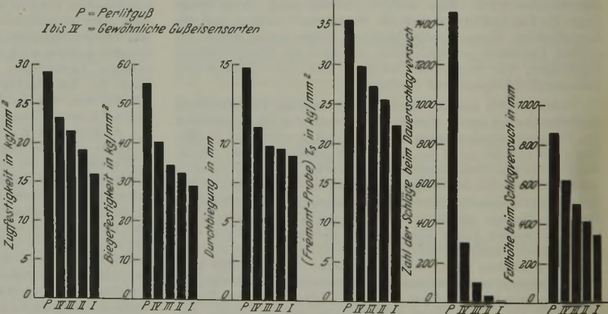
Abbildung 2. Vergleichende Festigkeitsversuche an Perlitguß (P) und vier gewöhnlichen Gußeisensorten.
