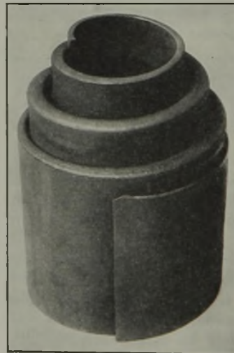
Abbildung 9. Gewaltbruch in einer Puffer-Schneckenfeder.
