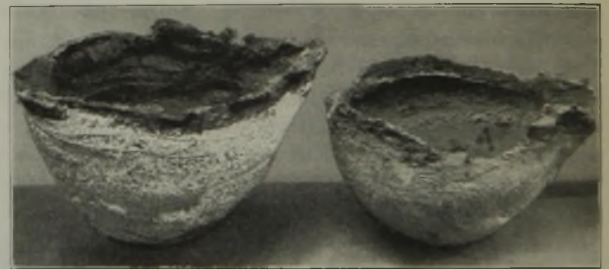
Abbildung 4. Gesinterte Herde aus geschmolzener Magnesia (innerste Schicht).
