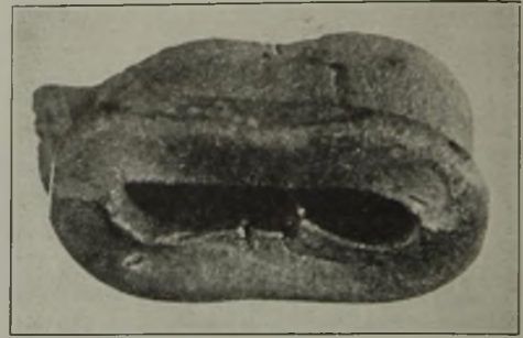
Abbildung 12. Plattgeschlagenes Tempergußstück mit Schale.
