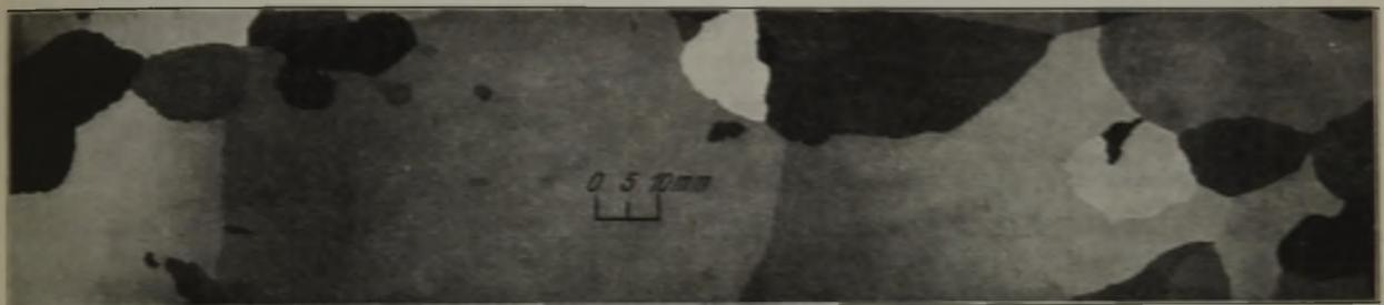
Abbildung 23. Korn eines 0,35 mm dicken Bleches aus Elektrostahl mit 0,016 % C, 2,75 % Si, 0,16 % Mn, 0,012 % P und 0,021 % S nach günstiger Rekristallisation.
