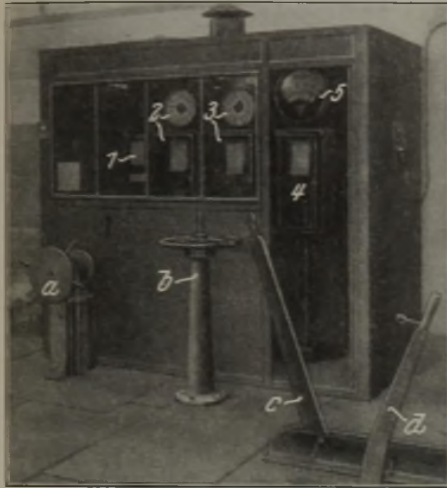
Abbildung 12. Bedienungsstand eines Siemens-Martin-Ofens mit Koksofengasbeheizung. Zusammenfassung der Meßgeräte und Bedienungsvorrichtungen. Große Anzeigergeräte, schreibende Ueberwachungsgeräte.
