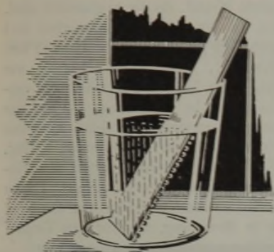
Abbildung 1. Wasserstoffentwicklung an einem schräg in angesäuertes Wasser gestellten Zinkblech.
