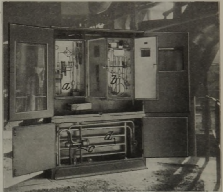
Abbildung 13. Laufende Ueberwachung der Abgaszusammensetzung an einem Siemens-Martin-Ofen mit Koksofengasbeheizung. (Nach Epping.) a = Ados-Kohlensäureschreiber c = zwangläufige Umschaltvorrichtung b = Omeco-Sauerstoffschreiber d = Warmwasserheizschlange (Ofenkühlwasser).
