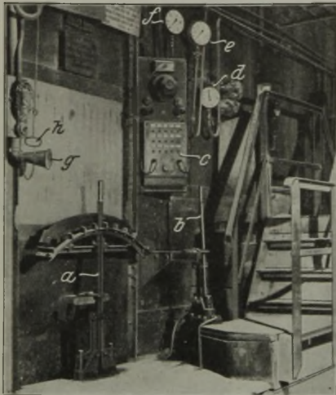
Abbildung 18. Bedienungsstand eines Konverters. a und b = Haupt- und Hilfssteuereinrichtungen der Schöttler-Steuerung c = Signaltafel d = Preßwasserdruck e und f = Winddruck in der Hauptleitung und am Konverter g = Sprachrohr zur Kalkbühne h = Sirene.
