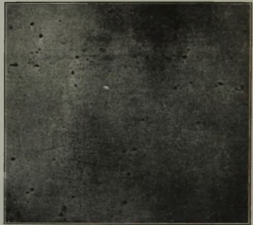
Abbildung 8. Von Säure angefressenes Eisenblech.
