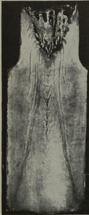
Abbildung 17. Aetzlängsschnitt durch einen beruhigten Stahlblock mit Auftriebsschlieren.
