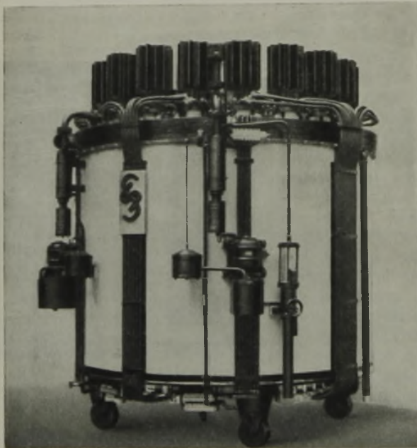
Abbildung 5. Stromrichter in Eisenausführung für 5000 A mit Steuergittern (mit 18 Anoden).
