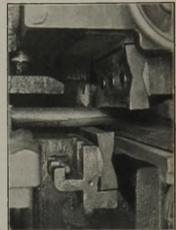
Abbildung 4. Wechseln der Scherenmesser in einer Schere nach Abb. 3 .
