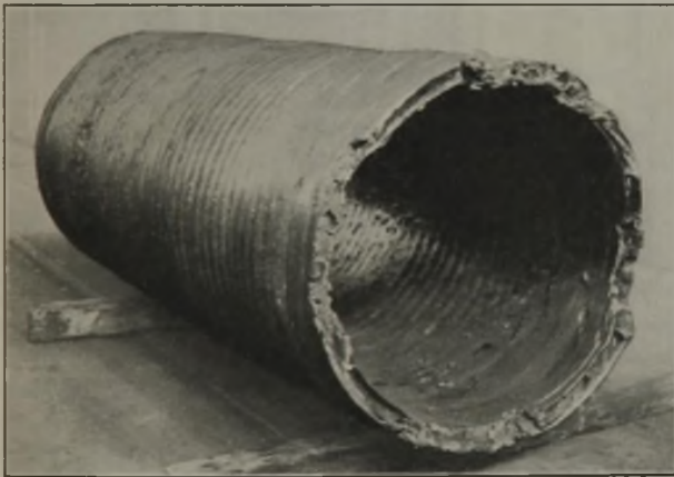
Abbildung 6. Bleiblock nach der Walzung.
