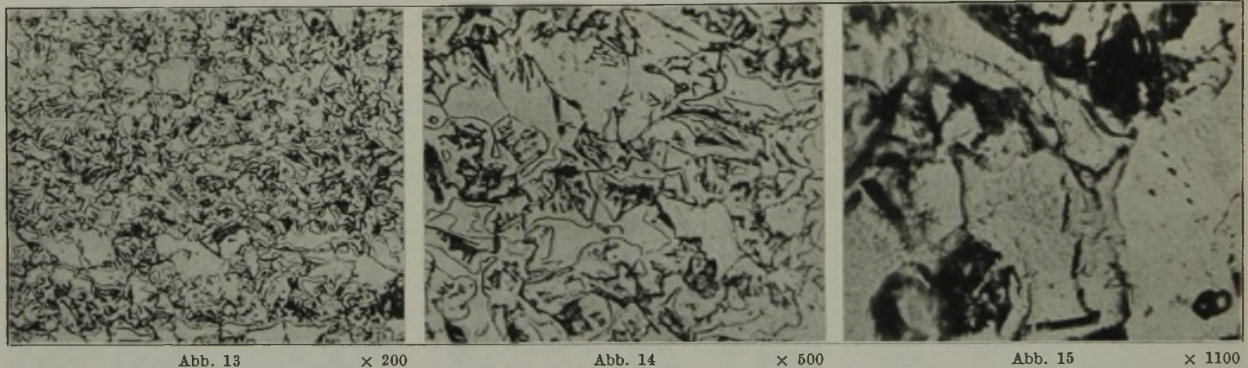
Abbildungen 13 bis 15. Gefüge des Rohres A an der Entnahmestelle der Abb. 11 und 12, jedoch nach absichtlichem Erhitzen auf 800° und Abschrecken im Wasserdampfstrom. (Aetzung mit alkoholischer Salpetersäure.)
