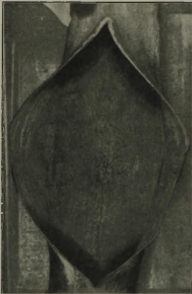
Abbildung 1. Im Betrieb entstandener Siederohrriß.
