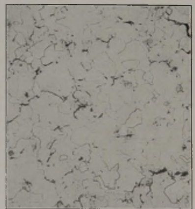
Abbildungen 42 bis 53. Veränderung des Gefüges von unlegierten Stählen durch Wasserstoffangriff. (×200.)
