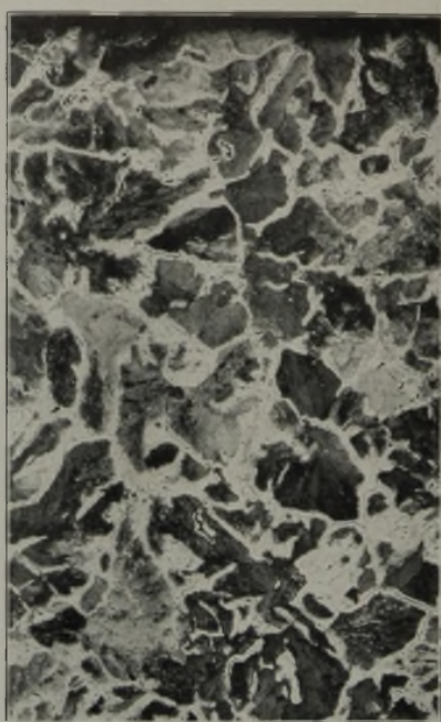
Abbildung 35 und 36. Wasserstoffangriff an einer grobkörnigen Probe (Stahl mit 0,76 % C, 10 h, 450°, 600 kg/cm 2 H 2 ).
