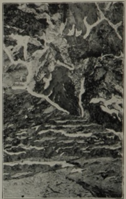
Abbildung 35 und 36. Wasserstoffangriff an einer grobkörnigen Probe (Stahl mit 0,76 % C, 10 h, 450°, 600 kg/cm 2 H 2 ).
