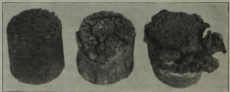
Abbildung 7 und 8. Anschliff einer Roheisenpfannen-Ausstampfung nach Berührung mit flüssiger Soda.
