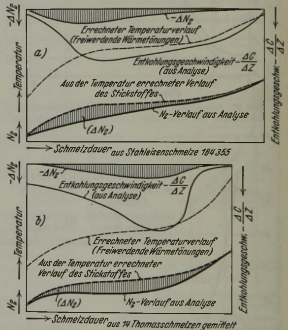
Bild 24. Beeinflussung des temperaturbedingten Stickstoffverlaufs durch die Entkühlungsgeschwindigkeit für Stahleisen- und Thomasschmelzen.
