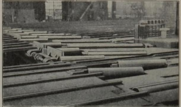
Bild 4. Schief liegendes Rollgangsstück, um die vom Ablaufrollgang des Kühlbettes kommenden Profilstäbe in die um  $30^\circ$  gegen den Rollgang versetzt liegende Zurichterei zu bringen.
