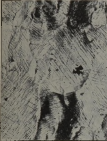
Bild 3. Fließlinien in den Kristallkörnern von Aluminium nach Dehnung bei Raumtemperatur. (Nach D. Hanson.) × 150
