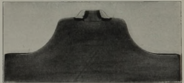
Bild 24. Aufschweißbiegeprobe aus einem Nasenprofil. ( \times rd. 3/7 .)
