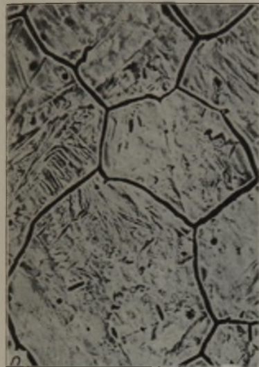
Bild 1. Austenitkorngröße von Stahl mit 0,07 % C für 1000 min Erhitzungszeit bei 1040° nach der Abschreckung in Quecksilber. (x 150.)
