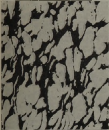
Bild 12. Gefüge eines Verbundkörpers mit 80 % W und 20 % Cu ( \times 70 ; geätzt mit Kupferammoniumchlorid).
