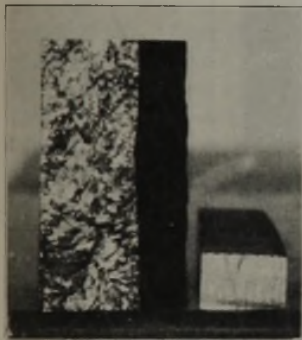
Bild 16. Bruchgefüge von Eisen-Nickel-Aluminium-Dauermagneten (links Guß, rechts Sinterlegierung).
