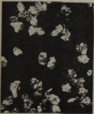
Bild 1. Durch mechanische Zerkleinerung gewonnenes grobes Eisenpulver ( \times 14 ).
