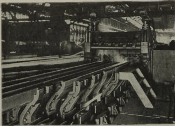
Bild 3. Mittelseisenstraße; Anstichseite des Vorgerüsts mit Kantwänden.
