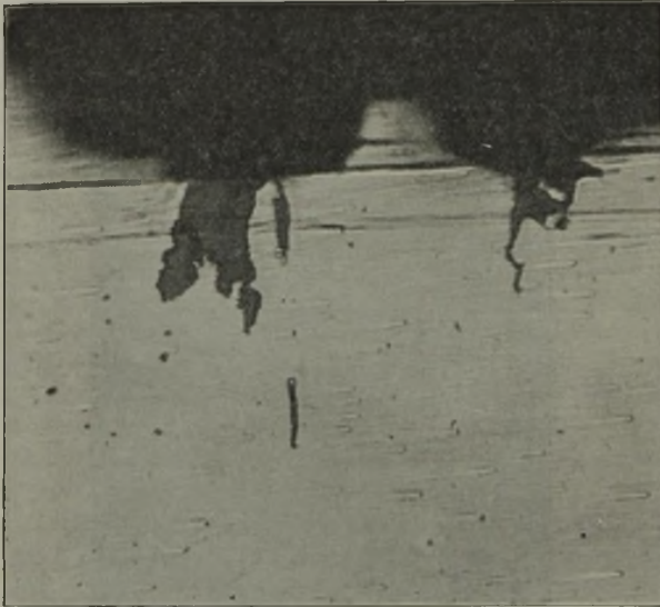
Bild 12. Druckfaltungsrisse nach dem Stauchen einer frei gebreiteten Zone.
