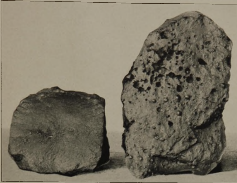
Bild 1. Bruchaussehen von Ferrowolfram. ( \times 0,40 .)
