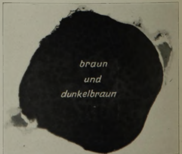
Bild 19. Saurer Einschuß im Ferromolybdän. ( \times 750 .)
