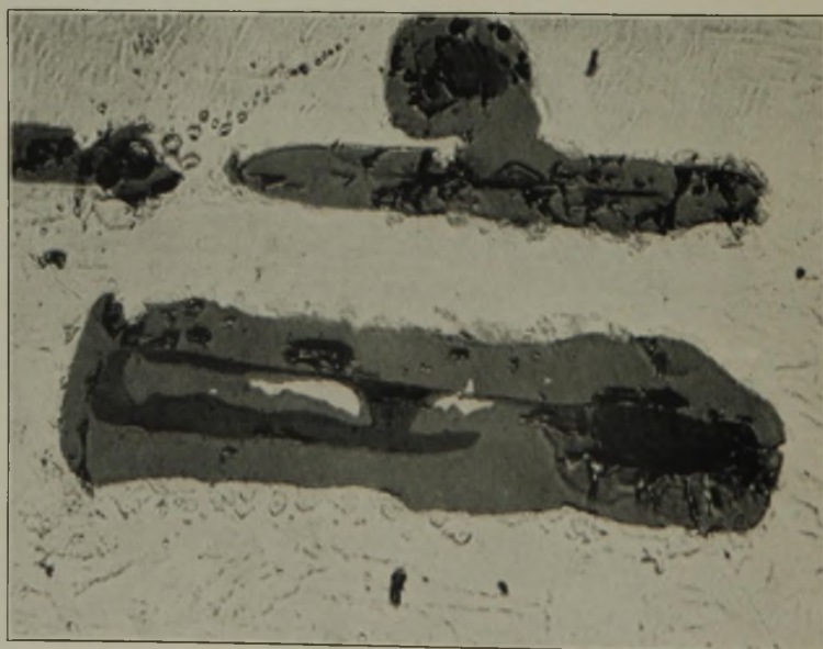
Bild 30. Linsenförmige Schlacken im Ferrovanadin (80 % V). ( \times 500 .)
