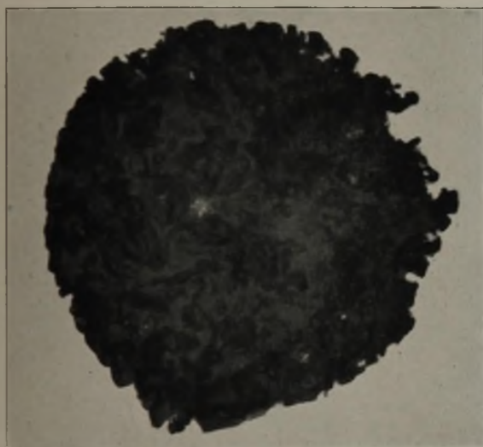
Bild 22. Kugeliger Einschuß im Ferrovanadin. ( \times 500 .)
