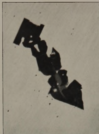
Bild 21. Spinellartiger Einschuß im Ferrovanadin. ( \times 500 .)
