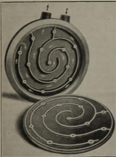
Bild 4. Heißwindschieberkeil mit spiralförmiger Wasserführung (sogenannte Spiralzunge).
