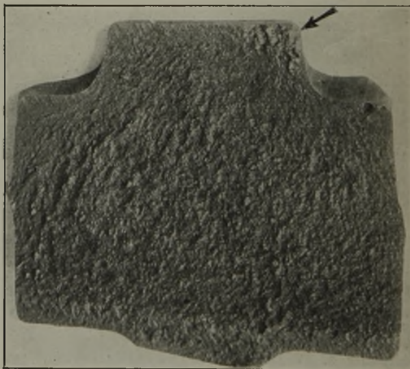
Bild 16. Kurzbruch einer Herzstückschiene mit verbrannter Ecke.
