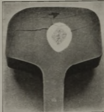
Bild 22. Querrisse in einer Schiene, von einem weichen Kern ausgehend. (Aetzung mit Kupferammonchlorid-Lösung.)
