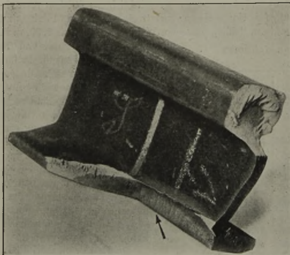
Bild 15. Fußlängsriß in einer Schiene, von Randblase ausgehend, mit anschließendem Querbruch.
