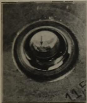
Bild 13. Hartmetallziehstein mit angeschweißtem Stahl. ( $\times 1\frac{1}{2}$ .)
