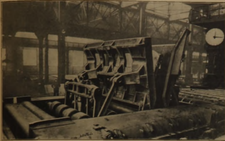
Bild 13. Wendevorrichtung beim Walzwerk von Marrel.
