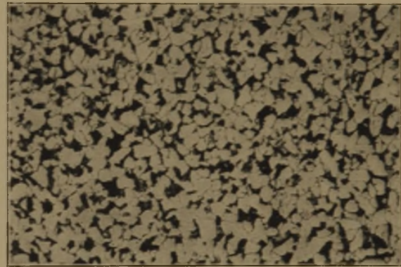
Rundstahl von 40 mm Dmr., Walzstand.
