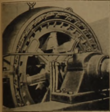
Bild 1. Ventilationsbleche an den Speichen des Motors.
