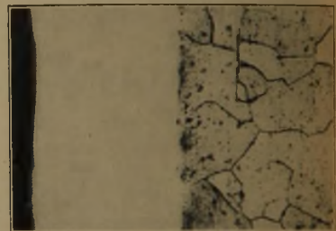
Bild 3. Mit alkoholischer Salpetersäure geätzt. (Nur das Kerngefüge wurde entwickelt.)
