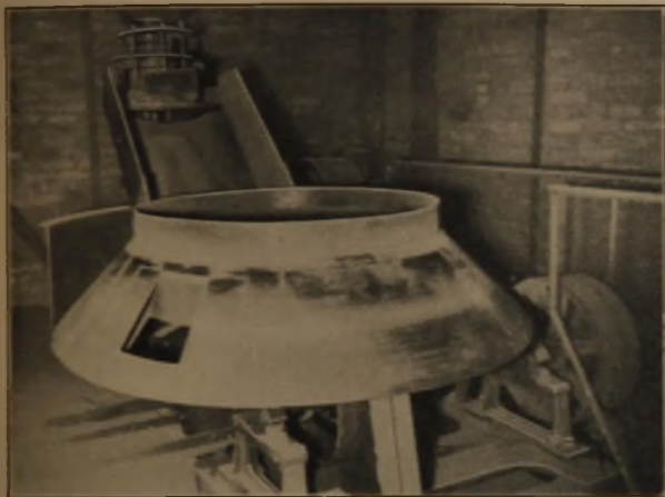
Bild 8. Drehteller und erster selbsttätiger Teiler.
