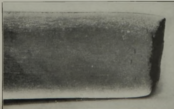
Bild 61. Bildung von Flockenrisse in einem Stahl mit 0,42 % C, 0,37 % Si, 0,52 % Mn und 1,53 % Cr bei Luftabkühlung nach 2-stündiger Wasserstoffglühung auf 1100° durch zusätzliche, gleichbleibende Zugbeanspruchung von 20 kg/mm 2 . Probe bei 200° im Wasserstoff erhaltenen Zustande 224 bis 224
