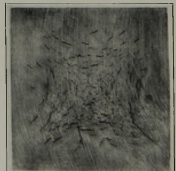
Bild 62. Anordnung von Flockenrisse in einem Vierkantknümel aus Stahl
