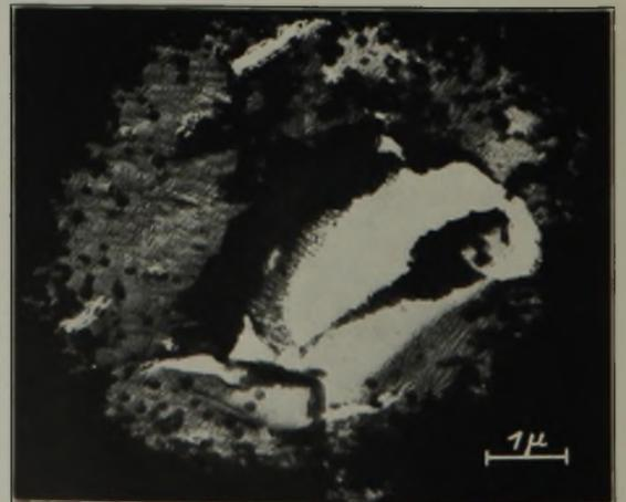
Bild 40. Elektrolytisch erzeugter Aluminiumoxydfilm.
