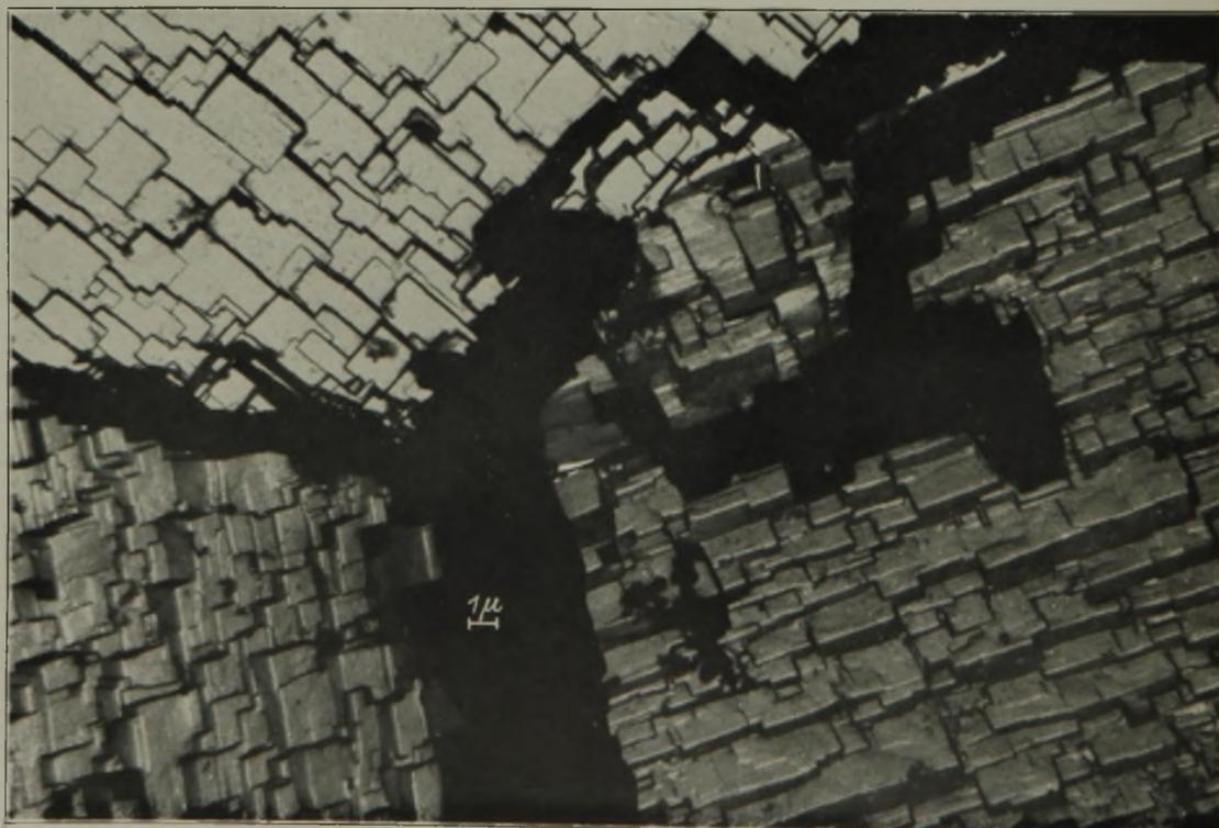
Bild 50. Abdruckaufnahme eines Aluminiumkristallgefüges. ( $\times 3500$ .)
