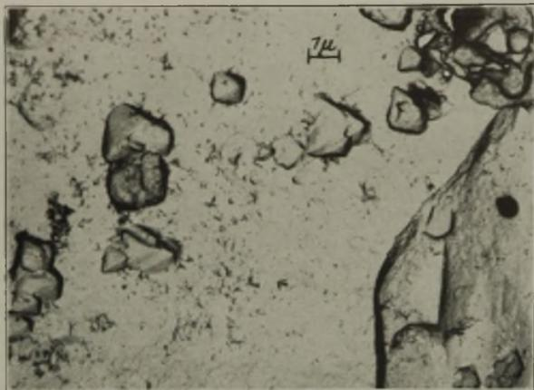
Bild 46. Uebermikroskopisches Oberflächenbild (Abdruckbild) von geätztem technischem Duralumin. ( $\times 5000$ .)
