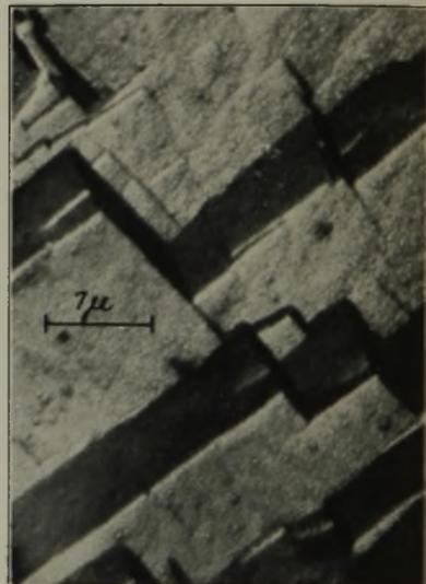
Bild 49. Abdruckaufnahme eines Aluminiumeinkristalles. ( $\times 13\,000$ .)
