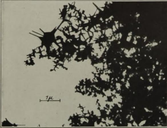
Bild 35. Zinkoxydrauch. ( $\times 9500$ .)
