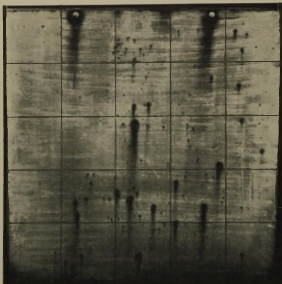
Bild 2. Einfluß der Größe der Stahlbleche bei Anstrichversuchen auf die Versuchsauswertung.
