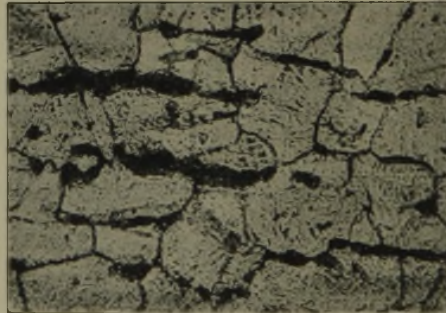
Bild 12. Von 1050° in Wasser abgeschreckt und 50 h bei 800° geglüht.
