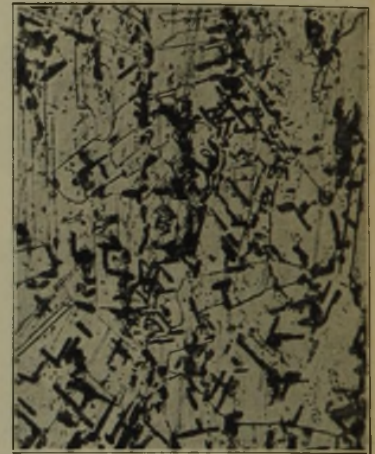
Bild 24. Gefüge nach Abschrecken von 1050° in Wasser und anschließendem 100stündigem Glühen bei 800°; Kerbzähigkeit (DVM): 2,5 mkg/cm 2 ; magnetische Sättigung: 160 Gauß.
