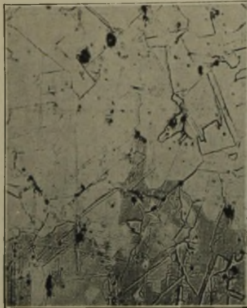
Bild 22. Gefüge nach Abschrecken von 1050° in Wasser; Kerbschlagzähigkeit (DVM): 19,3 mkg/cm 2 ; magnetische Sättigung: 210 Gauß.
