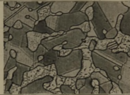
Bild 19 und 20. Stahl mit 0,14 % C, 3,0 % Si, 18,7 % Mn, 7,2 % Cr, 2,6 % Al und 40 % Ferrit.
