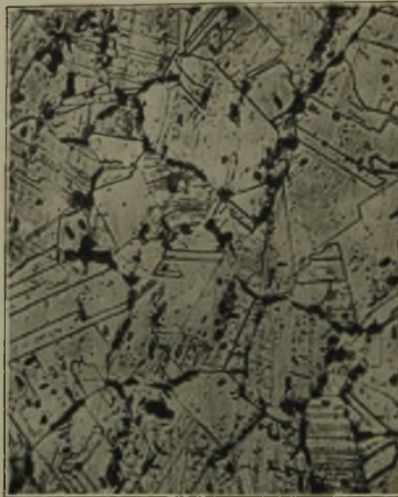
Bild 23. Gefüge nach Abschrecken von 1050° in Wasser und anschließendem 50stündigem Glühen bei 800°; Kerbzähigkeit (DVM): 3,6 mkg/cm 2 ; magnetische Sättigung: 170 Gauß.
