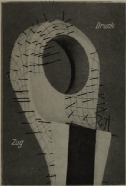
Bild 4. Modell zur Veranschaulichung der Spannungsverteilung in dem Gabelkopf der Pleuelstange eines doppelt wirkenden MAN.-Dieselmotors.
