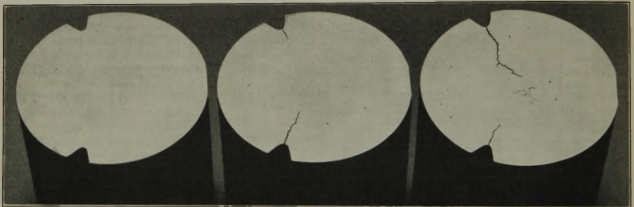
Bild 7. 3 min im Salzbad von 1240° erhitzt (nicht gerissen).
