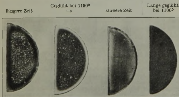
Abbildung 2. Auftreten von Martensitinseln im Kugellagerstahl mit steigender Glüh-temperatur und -dauer. (x 1)
