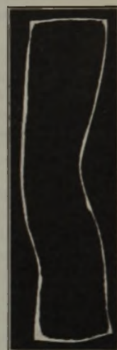
Nach dem Schneiden 2 h bei 700° gegläht, dann 170 h in schwefelsaurer Kupfersulfatlösung gekocht.
