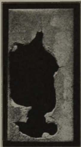
Nach dem Schneiden 2 h bei 700° gegläht, dann 20 h in schwefelsaurer Kupfersulfatlösung gekocht.
