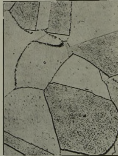
Von 1150^{\circ} in Wasser abgelöscht und bei 900^{\circ} geglüht.
