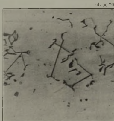
Abbildung 12. Ferrochromprobe mit Chromiteinschlüssen.
