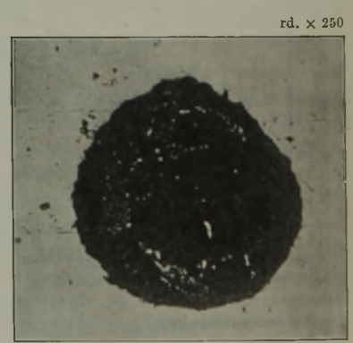
Abbildung 8. Chromitfreier Einschluß mit Chrommetalleinlagerungen.
