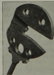
Abbildung 1 und 2. Pendelfallwerk (10-mkg-Pendelschlagwerk mit eingebauter Zusatzvorrichtung für den Kugelfallversuch).
