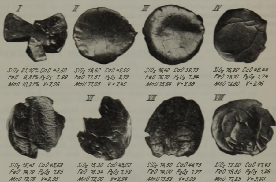
Abbildung 8. Netzschlacken verschiedener Art.
