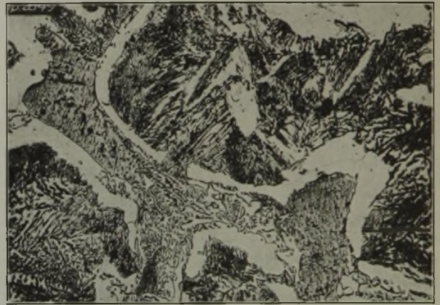
Abbildung 5. Luppe mit 0,55% C, 0,9% P und 0,9% S. \times 300
