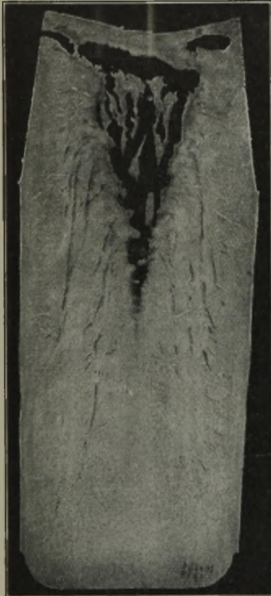
Abbildung 13. Block aus gleichem Stahl wie Abb. 8 , jedoch in einer auf 600^{\circ} erhitzten Schamotteform vergossen.
