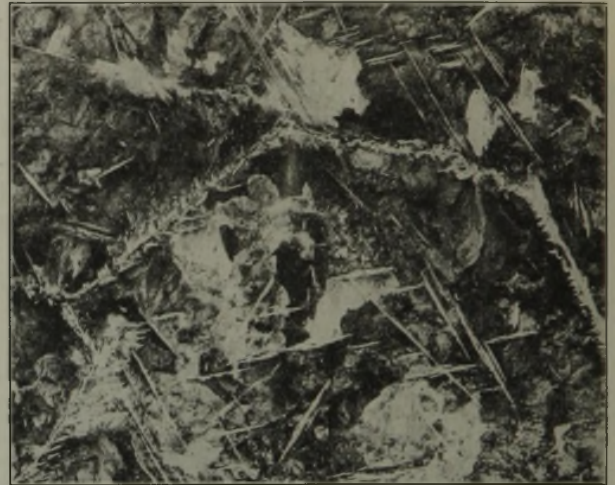
Abb. 3. Unlegierter Stahl mit 1,4 % C. ( \times 100 .)
