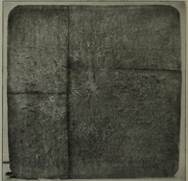
Abbildung 17. Schrumpfrisse in einem Stahlblock mit rd. 0,15 % C, 3,5 % Ni und 0,75 % Cr. ( \times \frac{1}{4} .)
