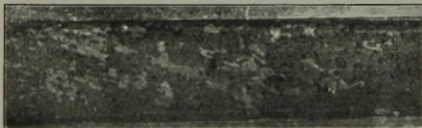
Abb. 15. Von Schmiedetemperatur erkaltet und bei 300° gebrochen. Abbildungen 13 bis 15. Bruchaussehen eines unlegierten Stahles mit etwa 0,65 % C nach verschiedenen Vorbehandlungen. ( \times 1 .)
