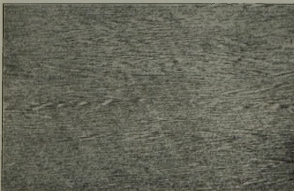
Abbildung 16. Dendritengefüge eines Bleches aus nichtrostendem Chromstahl. ( \times 1 .)
