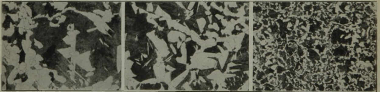
Verschmiedung 2fach (1020 mm Dmr.), geglüht.
